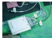
漁船に設置するデータロガー
