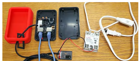
写真 3. 発停制御を行うノードとリレー
