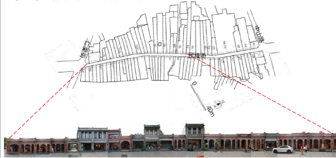
【三峡】（街路延長240m、間口平均5.84m）
