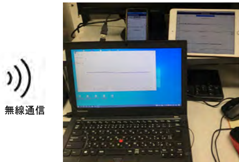
センサモジュールから発信された温湿度のデータを受信し、グラフ化できることを確認
