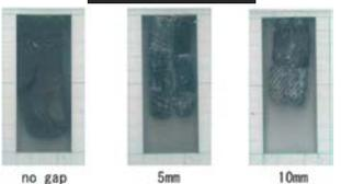
損傷 = 隙間が大きい
