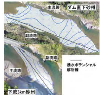
図-5 ドローンで計測した砂州地形と湧水ポテンシャル
