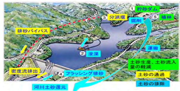
図-1 ダムの堆砂対策の分類
