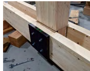
(c)60分以上圧縮を行い、治具を外す。その後、1週間養生。
