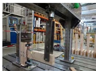
図2 接合部曲げ実験
