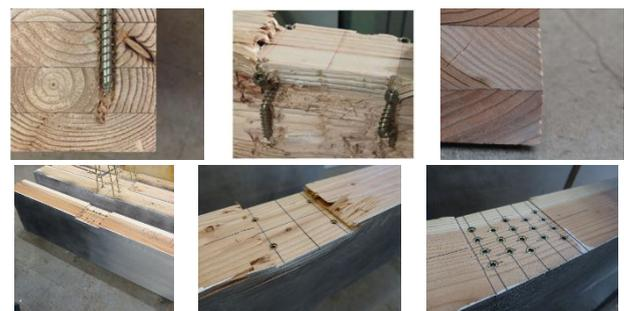
(a)ねじ押抜 (b) ねじ座屈 (c) ねじ先端木材の圧縮
