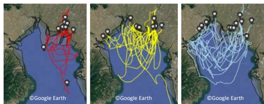
GPSボトルの比重による漂流軌跡の比較(左からボトルM, ボトルL, ボトルS). ピンは漂着地点もしくは最後に信号が受信された位置を示す.
