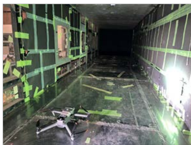
北海道大学 風洞実験室の測定部と実験機体 (DJI Mavic 3 Thermal)
