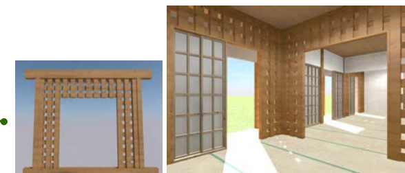
耐震補強用のパネルとしての活用
