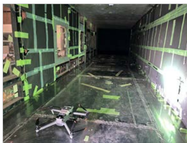
北海道大学 風洞実験室の測定部と実験機体 (DJI Mavic 3 Thermal)
